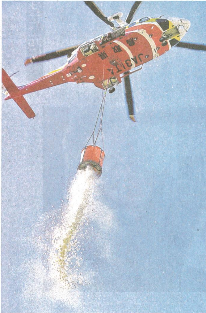
上空約30㍎地点からゲルパック消火剤を投下するヘリ。18日、鳥取市の鳥取港岸壁
